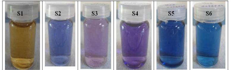
Phổ UV-Vis và màu sắc của dung dịch bạc nanoplates với các tỉ lệ khác nhau về nồng độ của [TSC]/[Ag^+]
